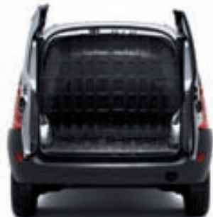
Angles d'ouverture des portes arrière (40°, 90° et 180°) et cloison complète*.
